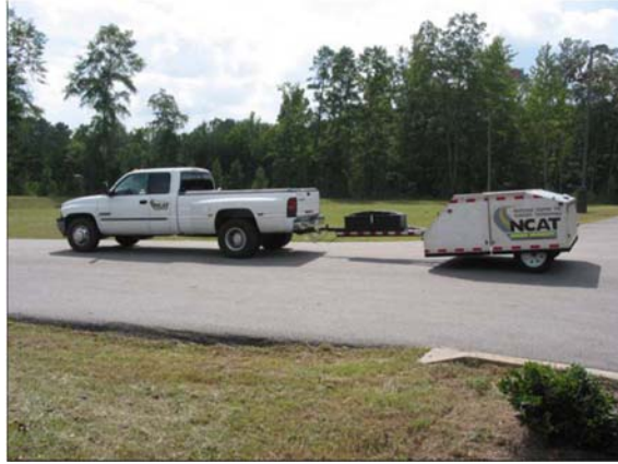
图 T 0987-3 拖车式CPX测试方法
