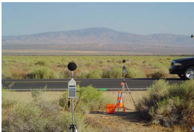
图 T 0986-5 远场法交通噪音测试
