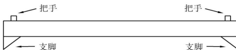
图 T 0973-1 路面横断面尺
